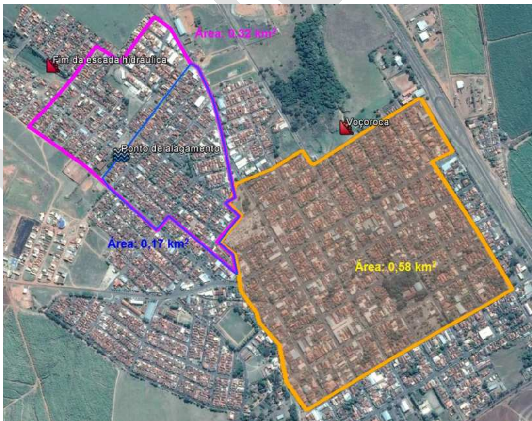
Figura 9.1 - Pontos críticos do sistema de drenagem
