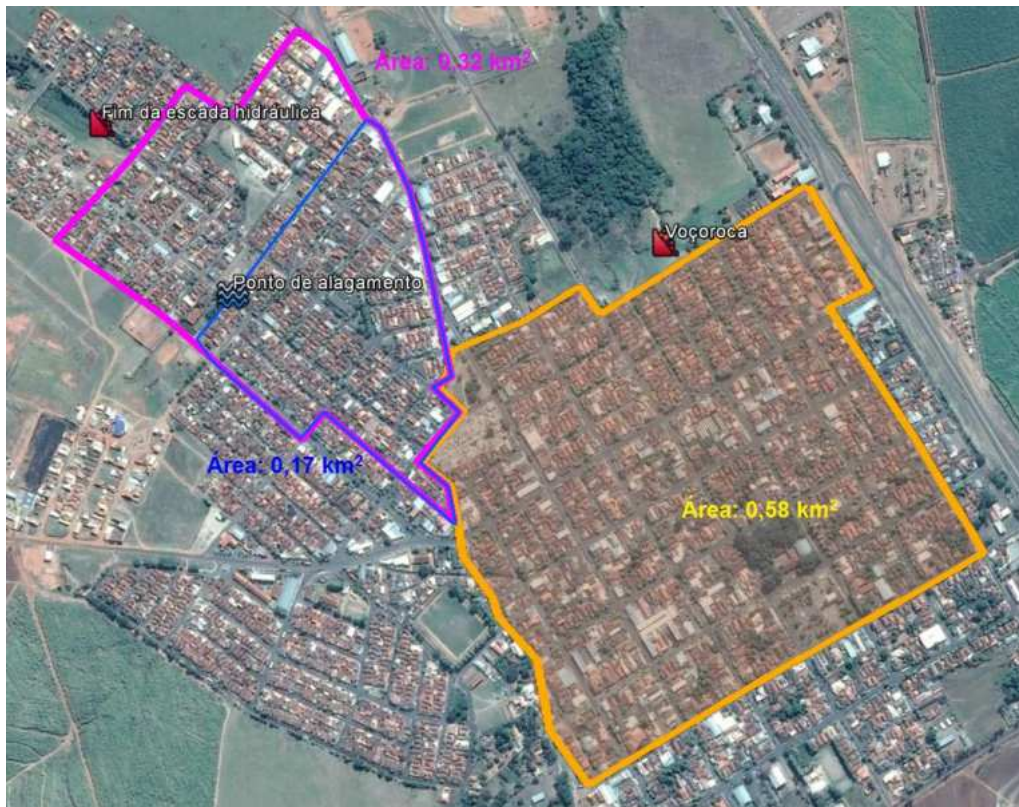
1425 1426 Figura 4.1 - Pontos críticos do sistema de drenagem 1427
